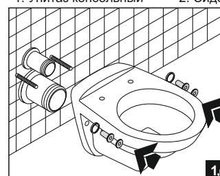
1,б Закрепить унитаз к инсталляции согласно инструкции, прилагаемой к инсталляции;
