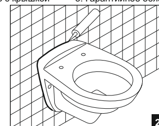
2,б При необходимости нанести герметик в зазор между стеной и унитазом;
